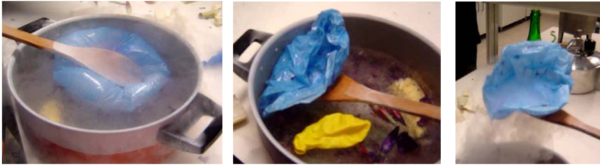
Figura 7- As contracções e expansões de volume da mistura gasosa proveniente do sopro (ar, vapor de água, CO 2 , etc.) contida no balão não obedecem à lei dos gases perfeitos PV=nRT ( P =pressão; V =volume; n =quantidade em moles; R = constante dos gases perfeitos; T = temperatura absoluta) dado que a esta temperatura tão baixa o comportamento será de uma mistura gasosa real, com equação de estado do tipo PV=znRT , corrigida pelo factor de compressibilidade z . Se esta experiência for feita com um balão cheio de N 2 (g) não há formação de líquido. Dentro do tacho (centro) também se podem observar lírios roxos e um pedaço de banana que se fizeram congelar em experiências anteriores [5].
