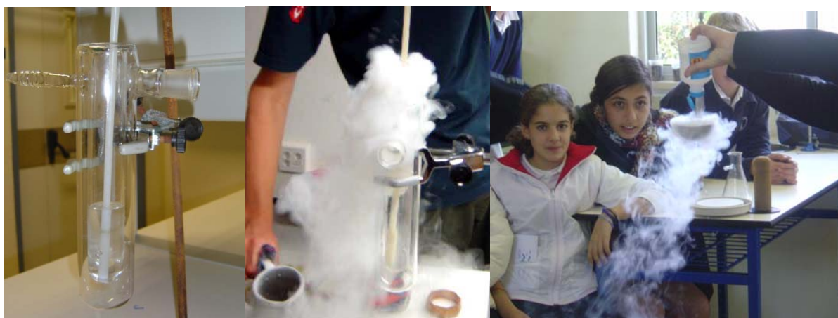
Figura 6 – O que muita gente não sabe é que o etanol só congela a -114 °C (!), apesar de entrar em ebulição a 79°C. É um líquido e peras! O tubo de vidro de dupla parede da esquerda contém etanol, ao qual se adiciona o N 2 (l) com agitação. Libertam-se abundantes fumos brancos por arrastamento do etanol líquido e água condensada da atmosfera. Agita-se até obter um slush que tem a textura de uma espécie de caramelo ou lama (centro). Mede-se então a temperatura com um termómetro digital de sonda apropriada. O slush também se pode formar misturando o etanol ao N 2 (l), num recipiente de metal ou vidro resistente, como se improvisou na figura à direita, com uma colher de sopa em alumínio. A mistura fica muito fria, viscosa e cheira bem. Finalmente, testa-se a temperatura do N 2 (l).
