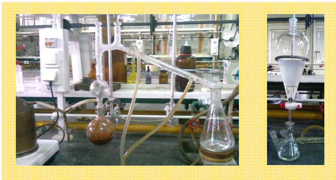
Figura 1 - Destilação por arrastamento de vapor da canela ( Foto de Filipe Rego, MEQ, 2º ano )
