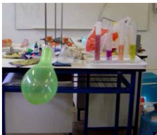
Figura 10 - A borracha usada no kitasato deve ser de boa qualidade e, se possível, o conjunto deve ser fixado num suporte como se mostra no caso do balão verde. Depois de ter rebentado o balão, mostra-se o kitasato a deitar fumos brancos e a largar os cristais de neve que entretanto o recobriram [6]
